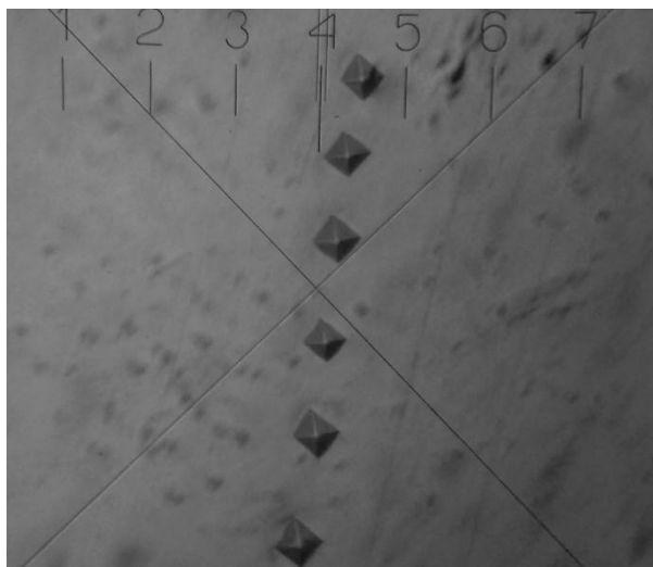
Рис. 7. Измерение отпечатков микротвердости на приборе ПМТ-3 ( \times 500 )
