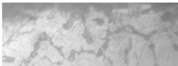
Рис. 6. Микроструктура поверхностного слоя вала из стали 40 ( \times 500 ):
