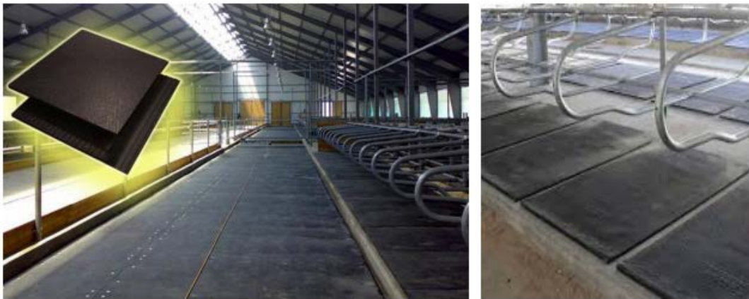
Рис. 2. Обладнання підлоги для тварин
