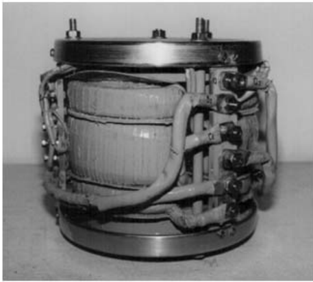
Рис. 3. Общий вид (а) и зависимости коэффициента изменения массы активной части (б) от геометрических управляемых переменных трехфазного трансформатора схемы (рис. 2, в) мощностью 6,3 кВ·А
