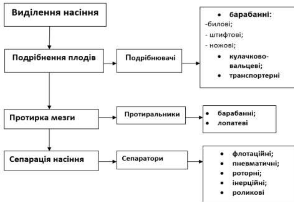
Рис.1. Класифікаційна схема подрібнююче-сепаруючих пристроїв
