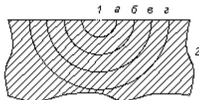
Рисунок.48. Схема поширення тепла в матеріалі заготовки: 1–точкове джерело тепла; 2 – заготовка
