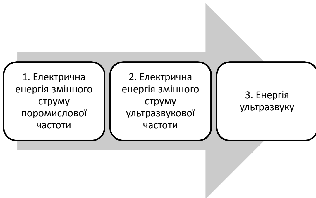
Рисунок 72. Блок-схема генерування ультразвуку: 1 генератор ультразвукової частоти; 2 - електроакустичний перетворювач; 3 - акустичний трансформатор
