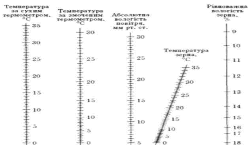
Рис 14. Планшетка РостНДІЗ для визначення можливості вентилування зернової маси при температурі повітря вище 0^\circ\text{C}
