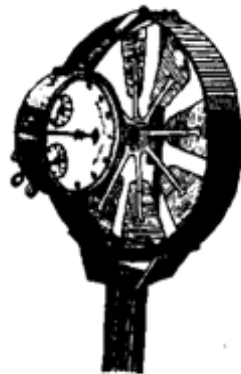
Рис. 3. Крильчастий ручний анемометр АСО-3
