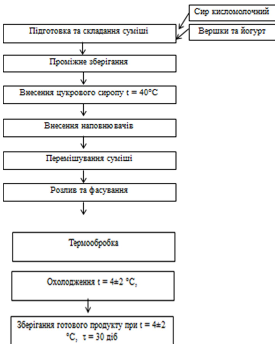
Рис. 9. Векторна схема виробництва сиркових десертів з наповнювачами
