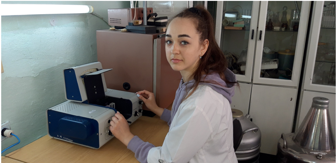
Рис. 8. Визначення концентрації спермійв за допомогою фотоелектрокалориметра КФК – 2
