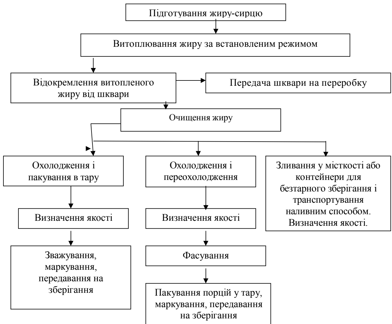
Рис. 8. Технологічна схема виробництва харчових топлених жирів з м'якого жиру-сирцю
