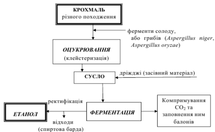
Рис. 21. Схема біотехнологічного отримання етанолу
