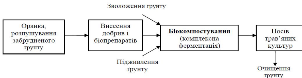
Рис. 31. Блок-схема мікробіотехнологічного очищення ґрунту від нафтового забруднення
