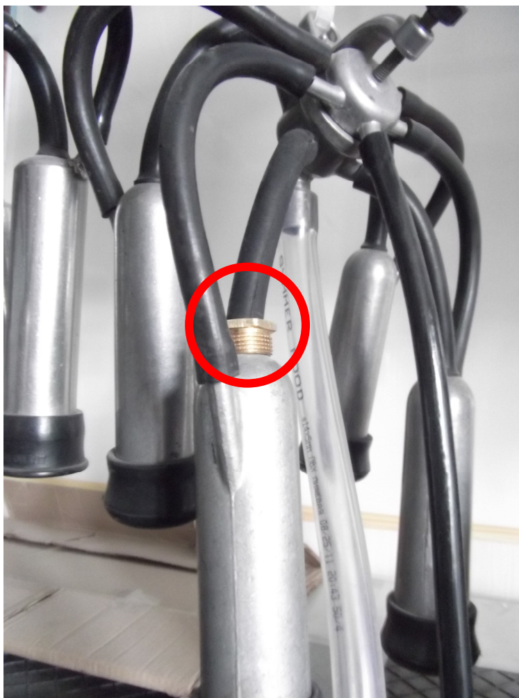
Рис. 3.42. Технологічне рішення натягу / послаблення дійкової гуми
