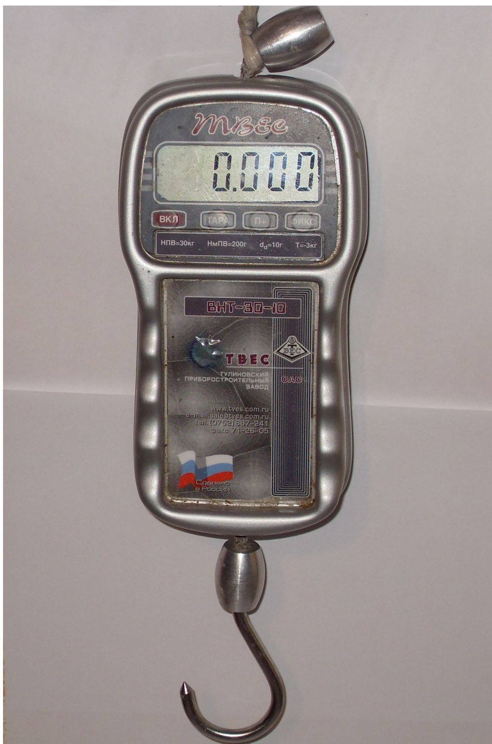
Рис. 1. Электронные весы фирмы “ТВЕС”, модель ВНТ-30-10 (цена подлшки 10 г)
