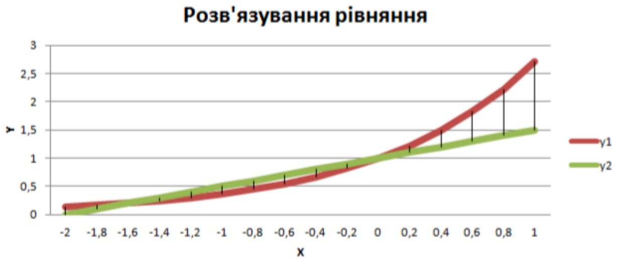
Рисунок 9 – Визначення координат точок перетину графіків функцій
