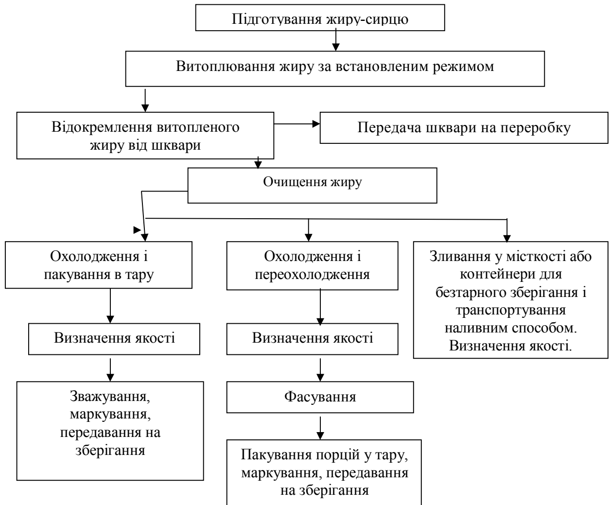
Рис. 7. Технологічна схема виробництва харчових топлених жирів з м'якого жиру-сирцю
