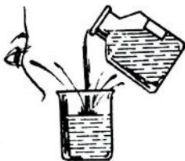
Мал. 4. Розбризування рідини під час наливання в посудину
