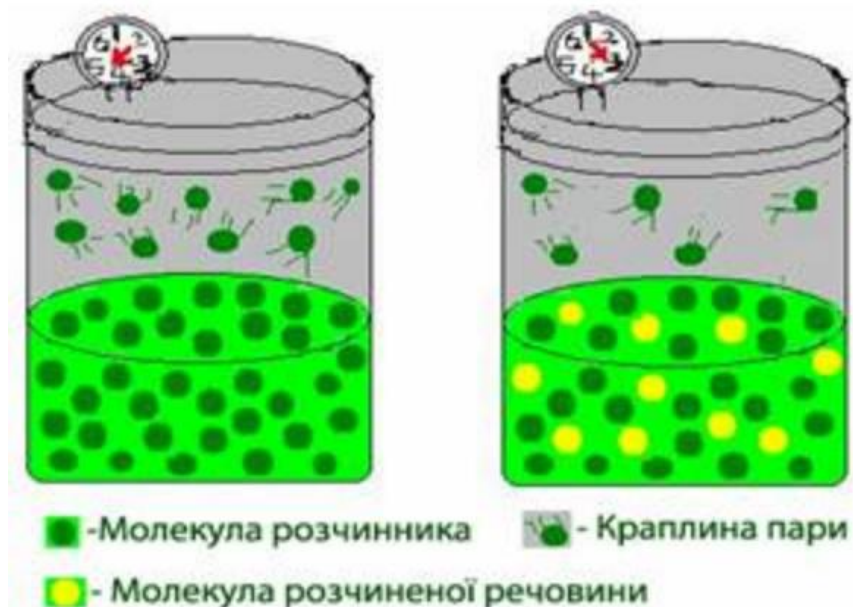
Рис. 2.2. Випаровування молекул розчинника у посудині з чистим розчинником та розчином
