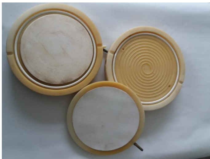
Рис. 3. Мембранний модуль установки
