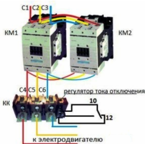
Рис. 7 – Реверсна схема магнітних пускачів
