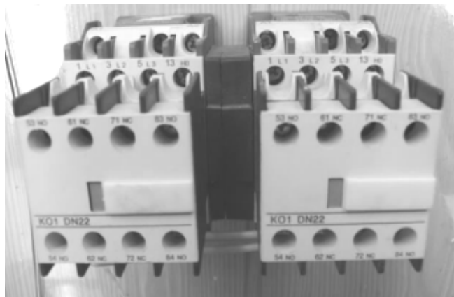
Рис. 2 – Контактор малогабаритний для реверсивного пуску двигунів
