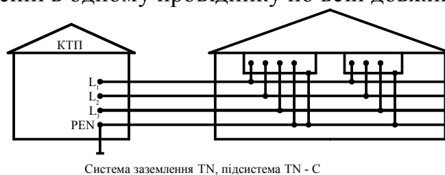
Система заземлення TN, підсистема TN - C
