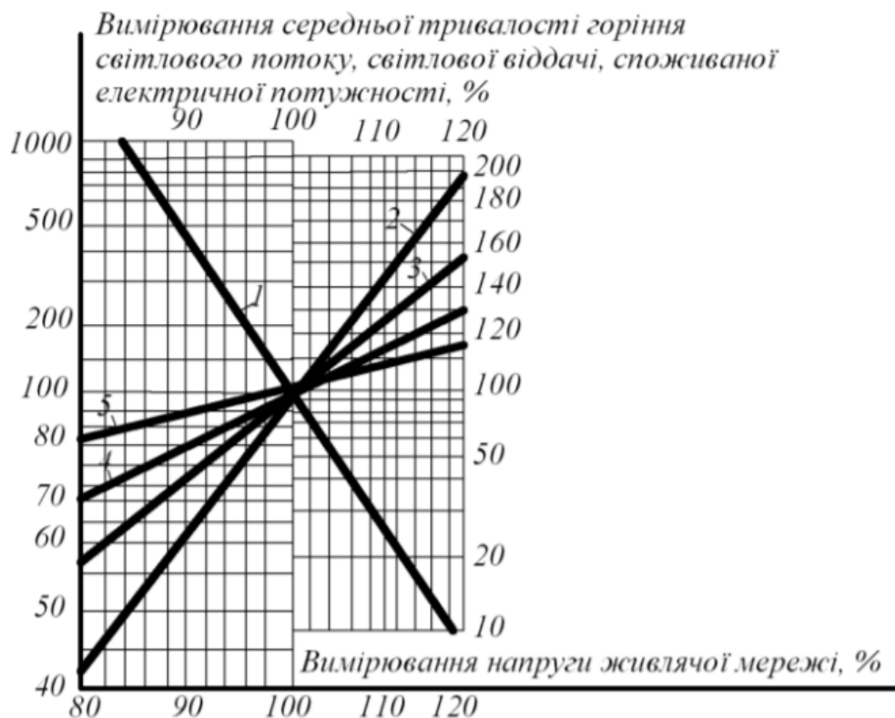
Рис. 2 - Залежність світлотехнічних, електричних і експлуатаційних параметрів ламп розжарювання загального призначення від зміни напруги живлячої мережі: 1 – середня тривалість горіння; 2 – світловий потік; 3 –
