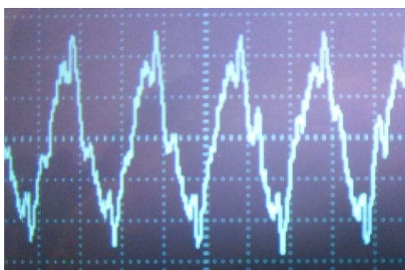
Рис. 3 — Осцилограма струму: а – на початку процесу електроплазмолізу; б – в кінці обробки електричним струмом зразка клітин цибулі
