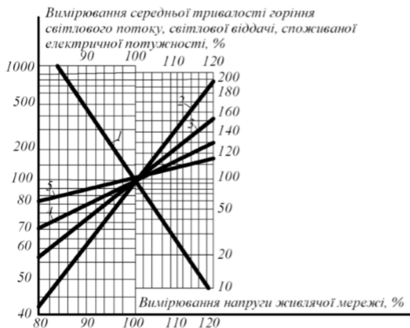
Рис. 4. – Залежність світлотехнічних, електричних і експлуатаційних параметрів ламп розжарювання загального призначення від зміни напруги живлячої мережі: 1 – середня тривалість горіння; 2 – світловий потік; 3 – світлова віддача; 4 – споживана потужність; 5 – сила струму.
