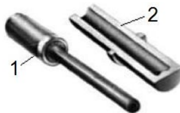
Рис. 17.9 – Електродний інструмент (1) деталі (2) після виконання копіювально-прошивної операції
