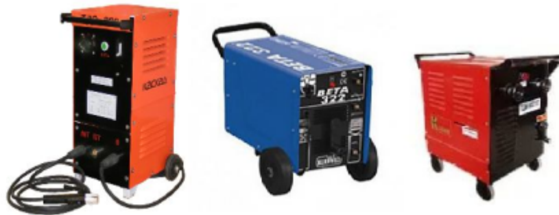
Рис. 14.6 – Загальний вигляд зварювальних трансформаторів
