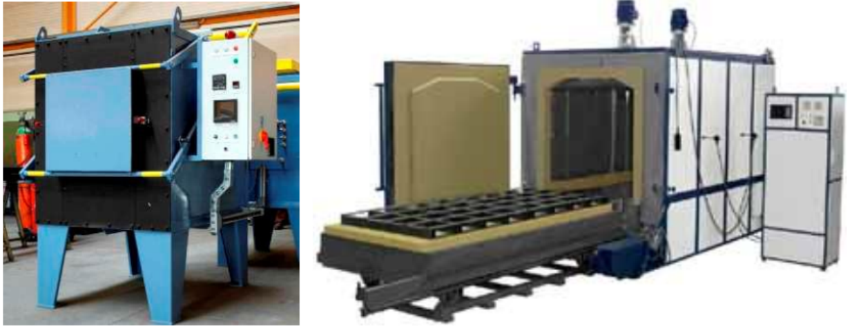
Рис. 12.3 – Електротермічні установки нагрівання опором
