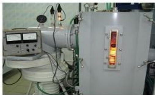
Рис. 12.4 – Установка прямого нагрівання: 1 – водоохолоджувальні затиски; 2 – виріб, що нагрівається; 3 – пічний трансформатор
