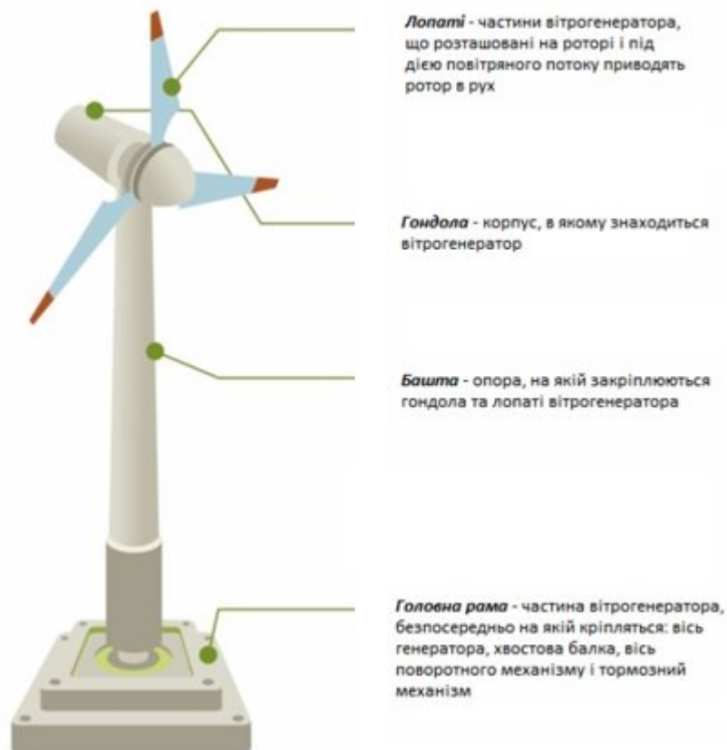
Рис. 9. 1. Основні конструктивні елементи вітрової установки
