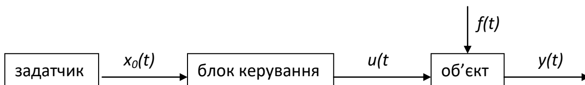
Рис. 2.2. Принцип розімкнутого керування
