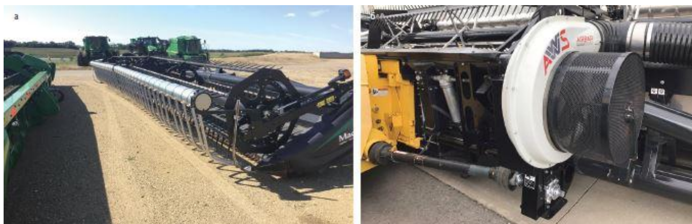
Рис.2.4. Система повітряної підтримки AWS Airbar (а) та її насос (б)
