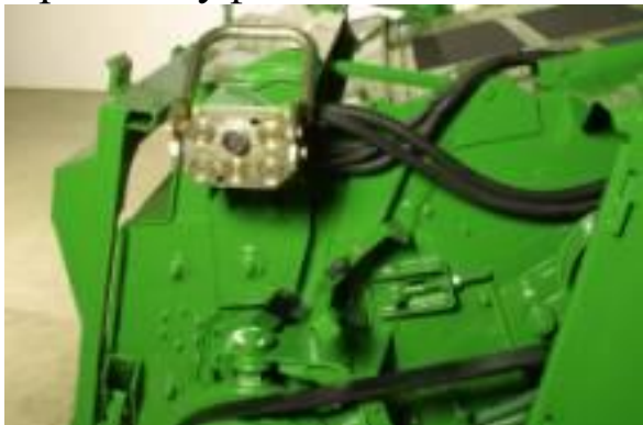
Рис.3.8. Розривна муфта комбайна Джон Дір серії CTS
