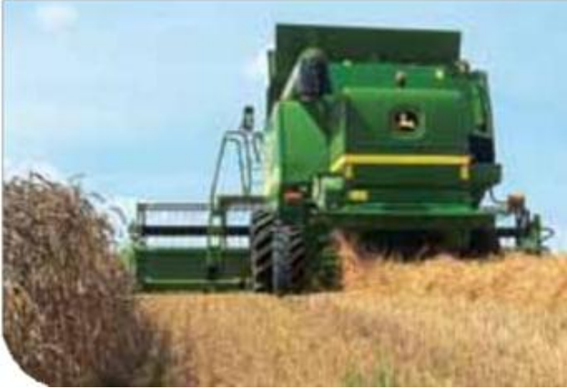
Рис. 6.4. Валкування полови разом із соломою.
