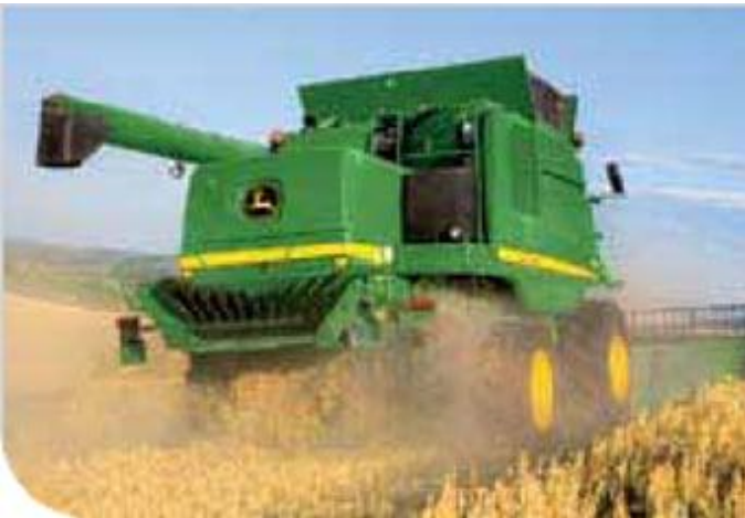
Рис. 6.5. Розкидання полови на сторони з одночасним валкуванням соломи.
