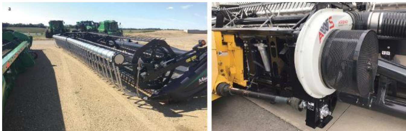
Рис.2.4. Система повітряної підтримки AWS Airbar (а) та її насос (б)
