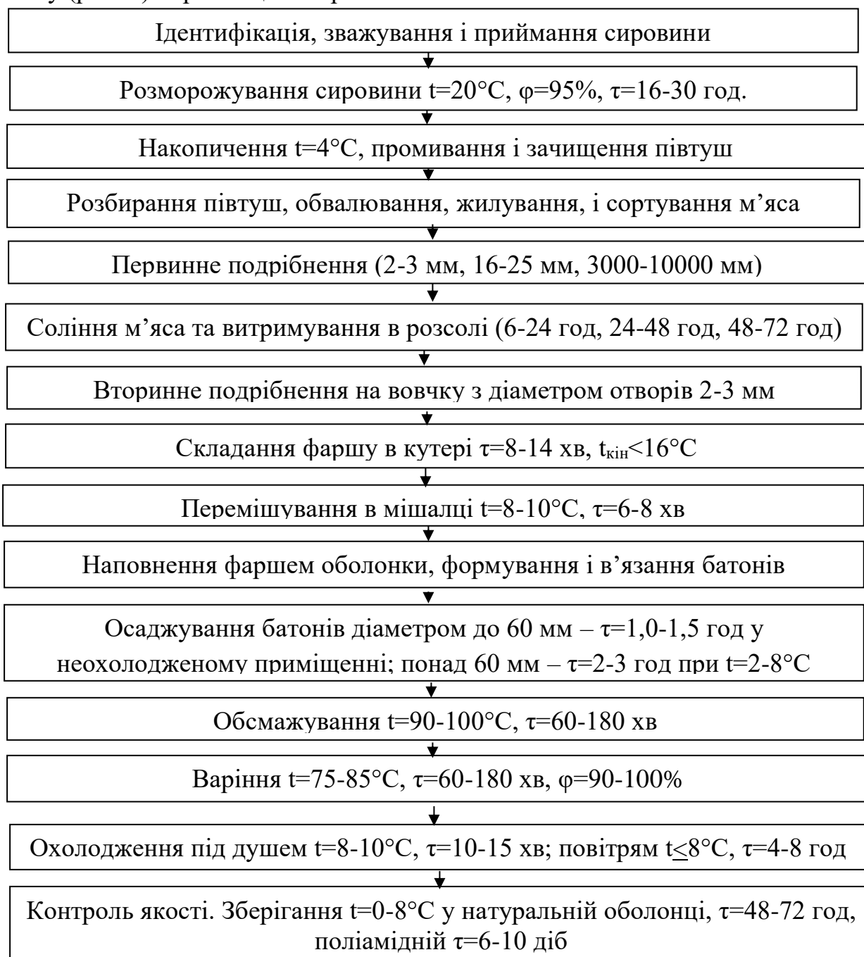
Рис. 1. Технологічна схема виробництва варених ковбас
