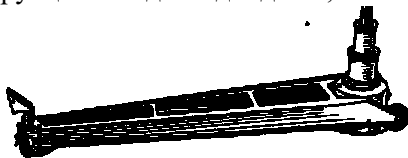
Рис. 7.6. Пересувний домкрат на 12,5 т (модель П-308)
