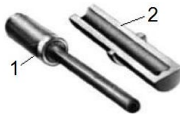
Рис. 17.9 – Електродний інструмент (1) деталі (2) після виконання копіювально-прошивної операції
