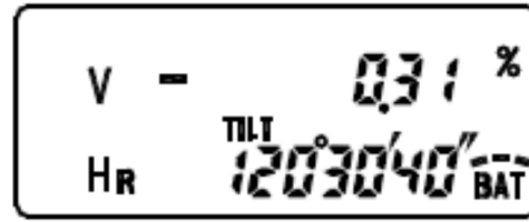
Рис. 4.7 – Режими відображення вертикального кута а – режим зенітної відстані; б – режим кута нахилу
