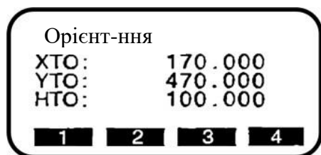
Рис. 7.5 Вікно <Координати> для вибору пункту «Орієнтування станції»
