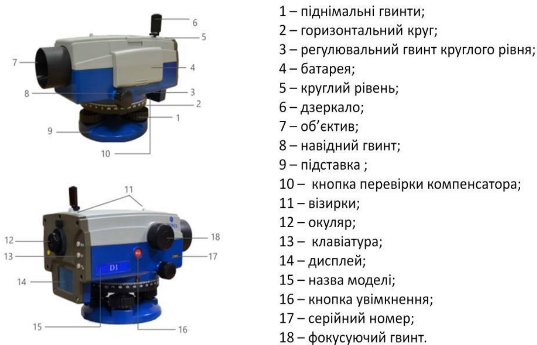
Рис. 5.1. Будова цифрового нівеліра Stonex D1
