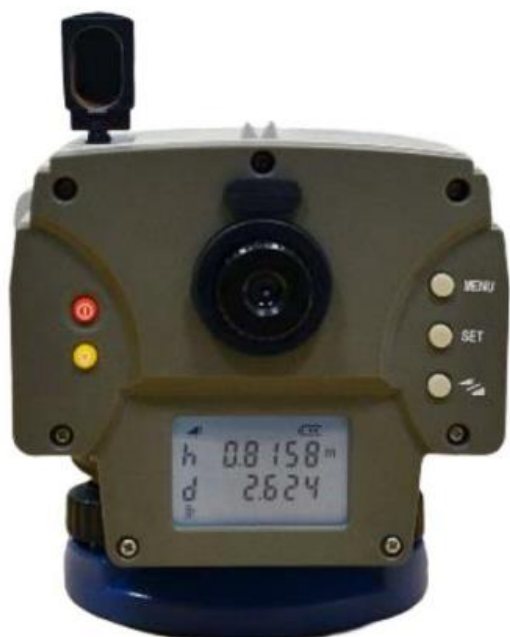
Рис. 5.2. Панель керування цифрового нівеліра Stonex D1
