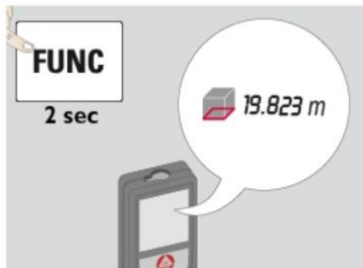
Рис. 2.3 Обчислення периметра в режимі вимірювання площини
