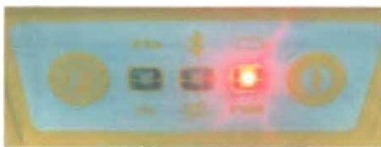
Рисунок 9.5 – Індикація статичного режиму роботи
