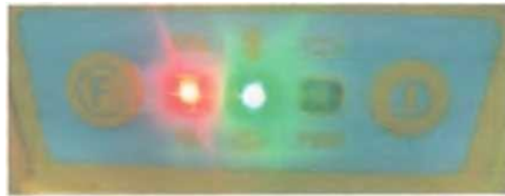
Рис. 9.3 Індикація режиму ровера з увімкненим GPRS–каналом
