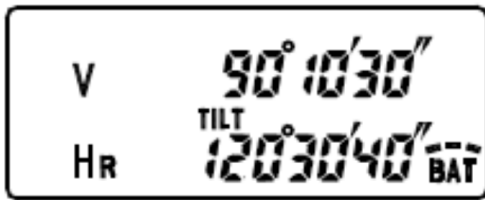
Рис. 4.7 – Режими відображення вертикального кута а – режим зенітної відстані; б – режим кута нахилу
