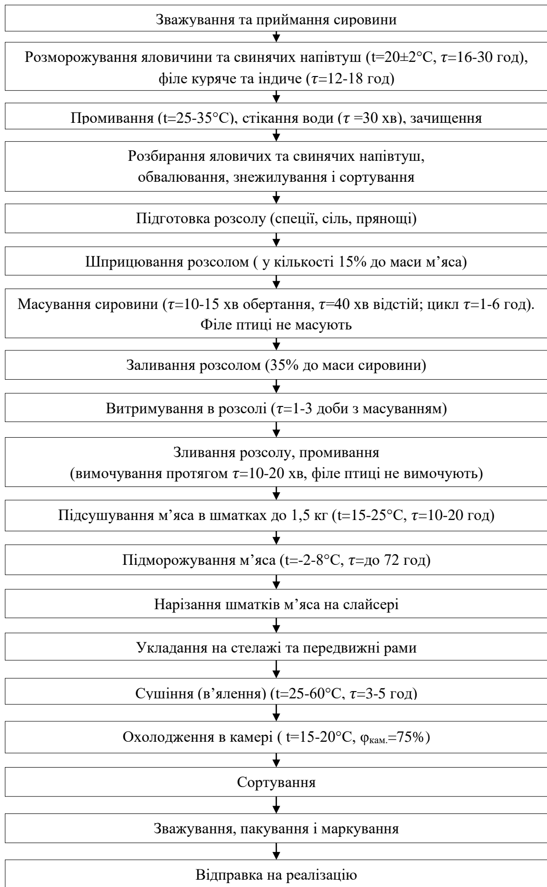
Рис. 4. Загальна технологічна схема виробництва м'ясних снеків
