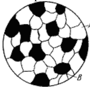
Рис. 18. Схема мікроструктури механічної суміші
