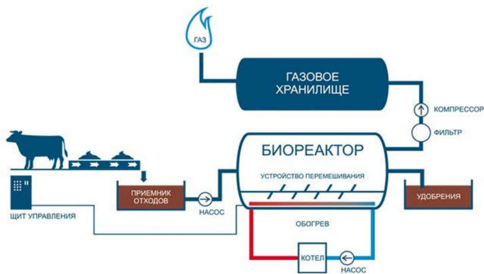
Рис.18 . Схема роботи біогазової установки на відходах тваринницьких ферм [21]
