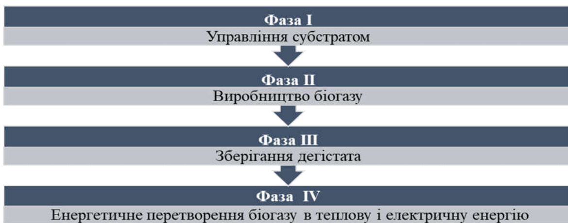
Рис.7. Фази виробничого процесу біогазу
