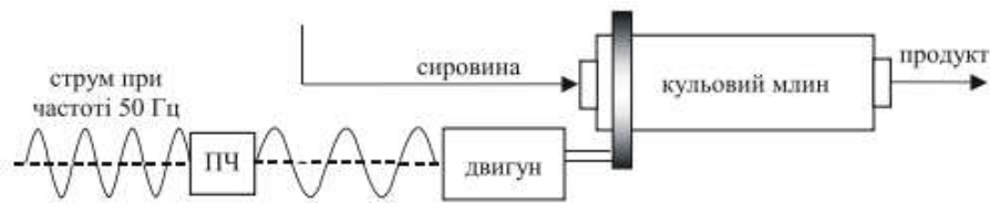
Рис. 11.13 – Схема кульовому млині - ПЧ
