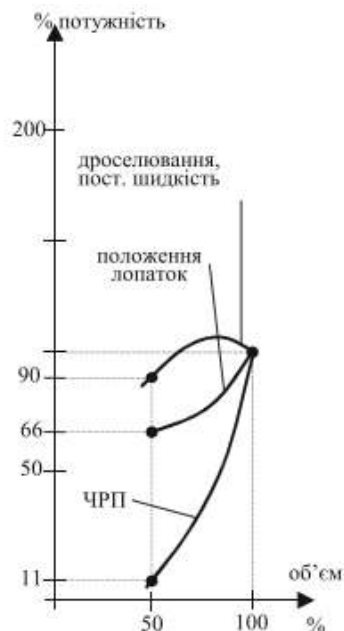
Рис. 11.6 – Зображення потужності вентилятора залежно від трьох методів регулювання повітряного потоку
