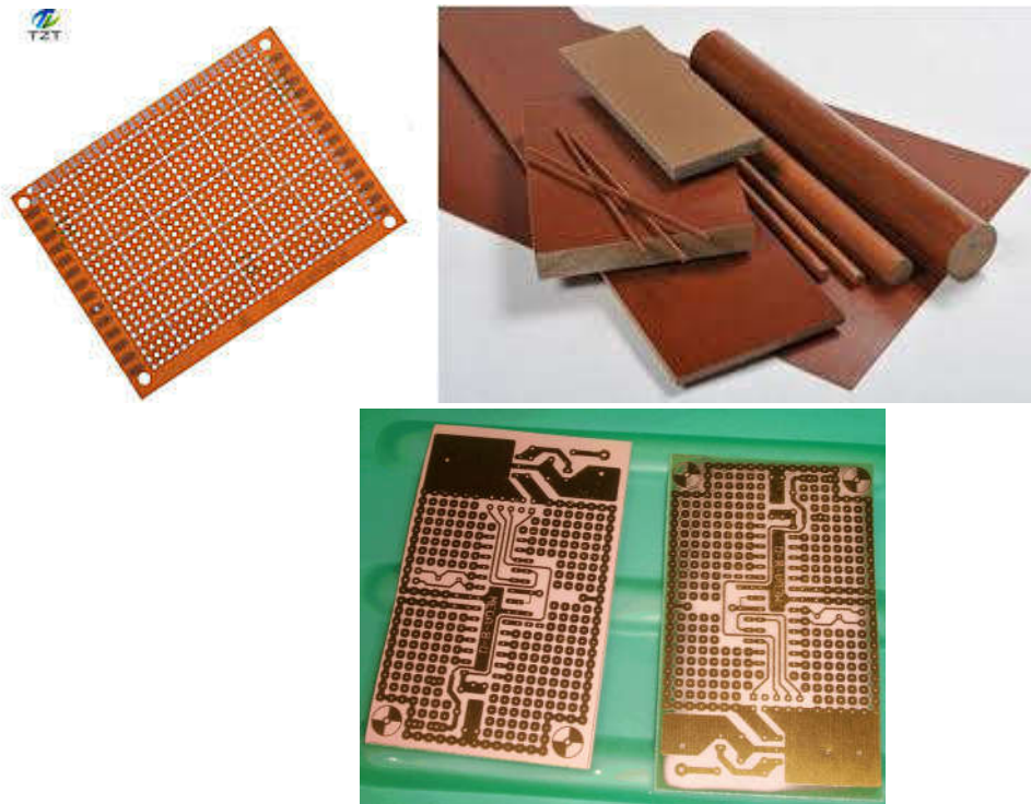
Рис. 3.4 – Вироби з фольгованого гетинаксу і текстоліту
