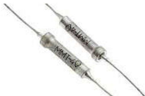
Рис. 5.8 – Зображення терморезистора ММТ-1 і ММТ-4.
