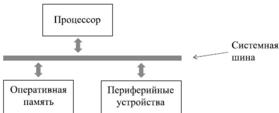
Рис. 1. Загальна схема типової ЕОМ, заснованої на архітектурі фон Неймана
