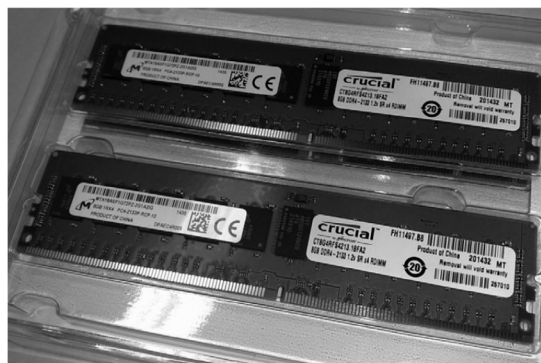
Рисунок 3 - Дві друковані плати з оперативною пам'яттю об'ємом по 8
