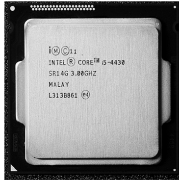
Рисунок 2 - Інтегральна схема - мікропроцесор Intel Core i5
