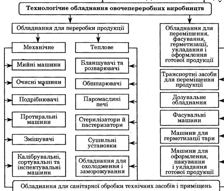
Рис. 11.1. Класифікація технологічного обладнання для переробки плодоовочевої продукції
