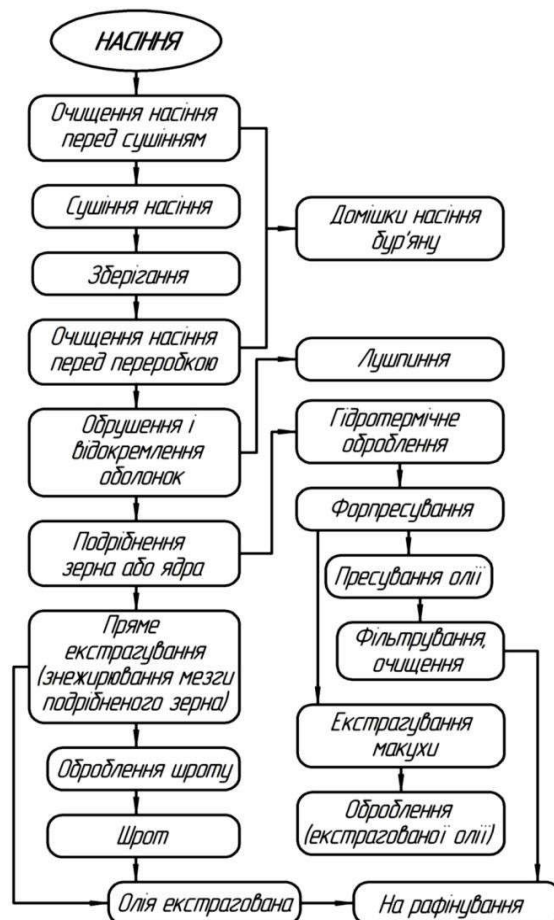
Рис. 7.1. Технологічна схема виробництва олії
