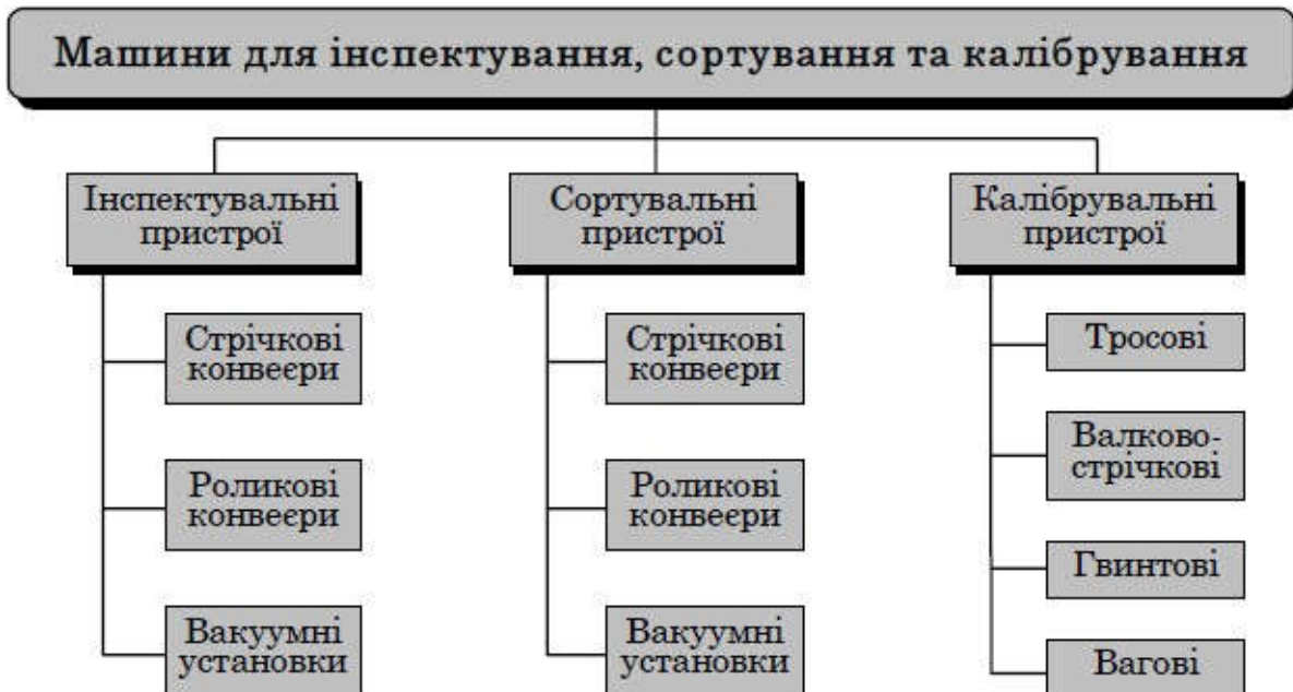
Рис. 11.3. Класифікація машин для інспектування, сортування та калібрування плодовоовочевої сировини
