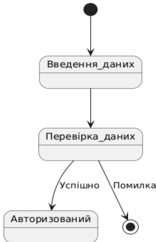
Рисунок 3.5 – State Diagram (Діаграма станів авторизації користувача)
