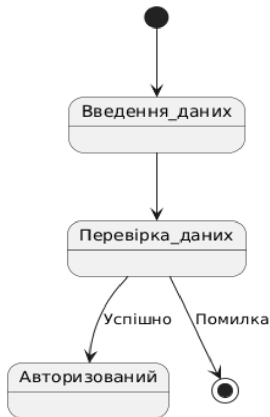
Рисунок 3.5 – State Diagram (Діаграма станів авторизації користувача)
