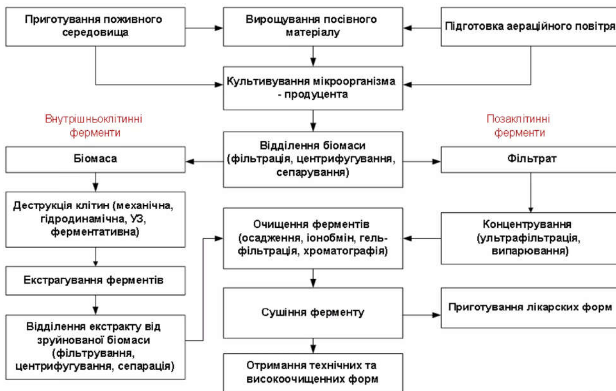
Рис. 11. Загальна схема отримання ферментів мікробіологічним шляхом
