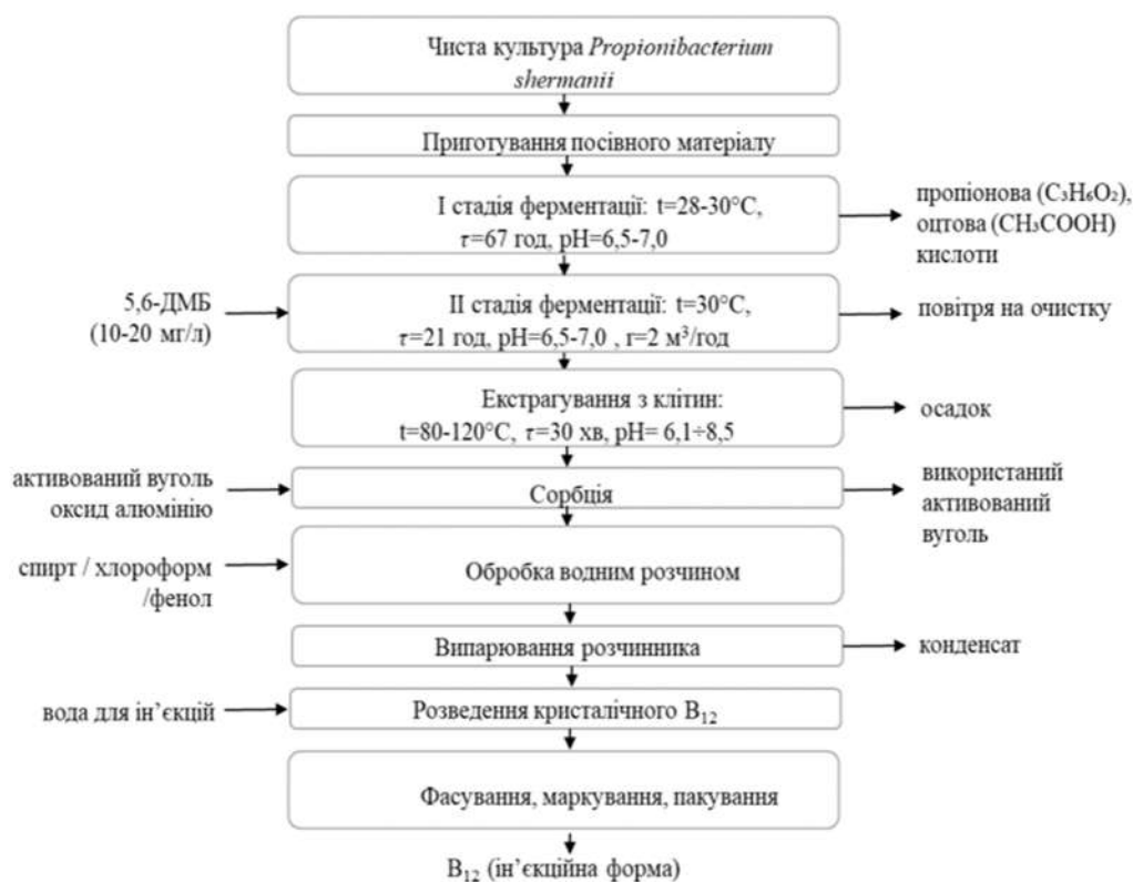
Рис. 19. Технологічна схема отримання вітаміну B 12
