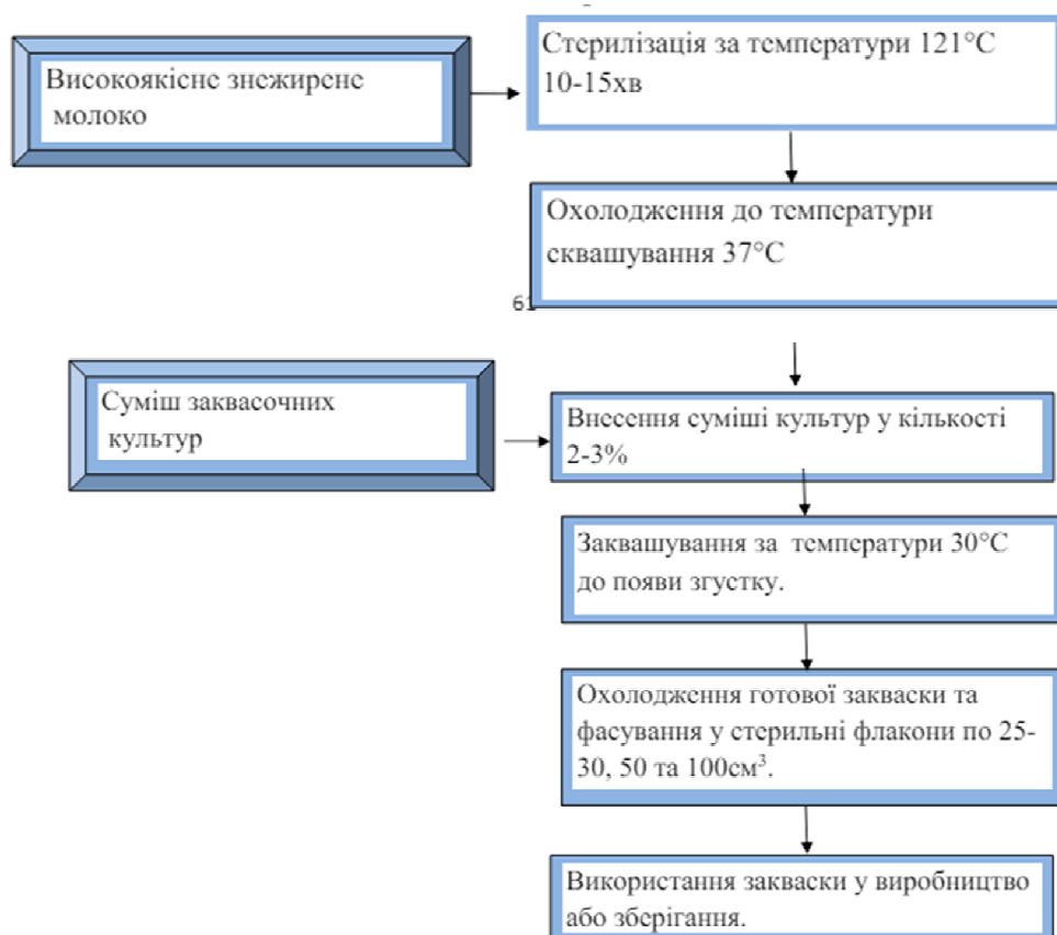
Рис. 22. Схема виготовлення рідкої закваски
