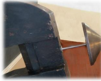
Рисунок 3.6 – Зразок вкручений у маятниковий пристрій.
