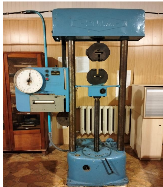
Рисунок 4.1 – Схема універсальної розривної машини УММ-5. 1 - нижня траверса; 2 - нижній затискач; 3 - випробовувальний зразок; 4 - верхній затискач; 5 - важіль маятника; 6 - силовимірювач; 7 - діаграмний апарат; 8 - напрямок розтягування зразка; 9 - чавунна литая станина; 10 - вантажний гвинт.
