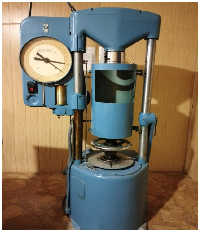
Рисунок 2.22 – Загальний вигляд випробувальної машини КМ-501
