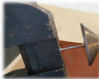
Рисунок 4.36 – Зразок вкручений у маятниковий пристрій.
