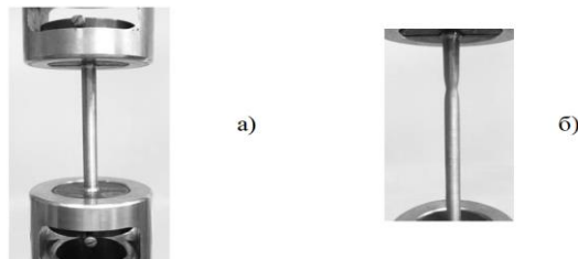
Рисунок 4.10 – Зразок в затискачах випробувальної машини: а) на початку випробувань, б) перед руйнуванням.
