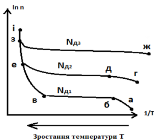
Рис. 5.3 – Типові залежності концентрації носіїв заряду у напівпровіднику від температури при різній концентрації донорних домішок ( N_{д1} < N_{д2} < N_{д3} )
