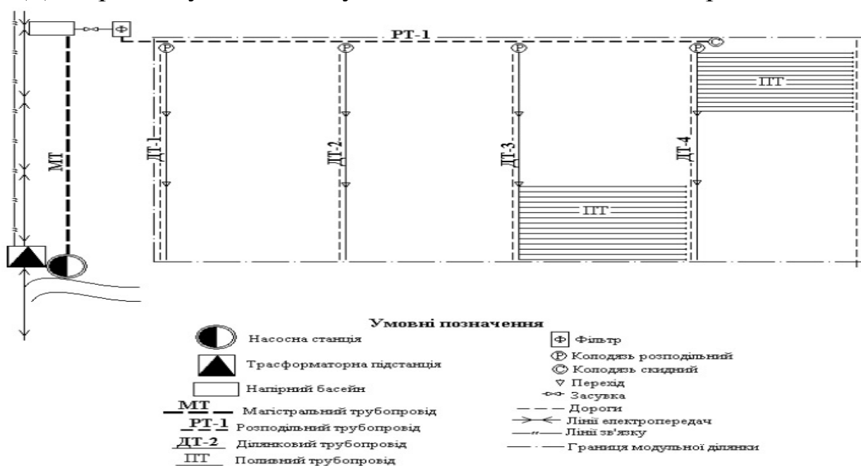
Рис. 4 Схема модульної ділянки краплинного зрошення
