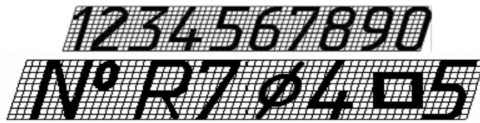
Рис. 1.5. Форма і конструкція арабських цифр
