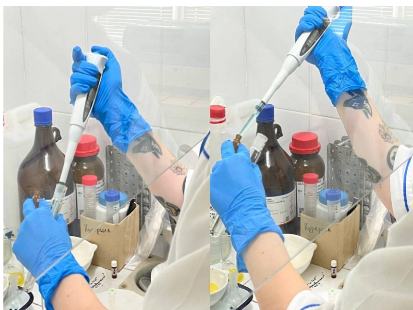
Рис. 7. Пробопідготовка м'ясного зразку до випробування на вміст ЗКА
