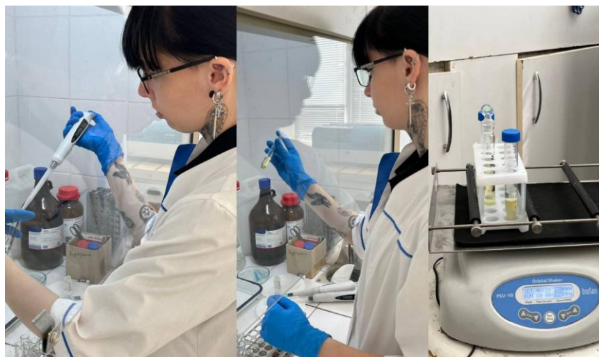
Рис. 5. Пробопідготовка молочного зразку до випробування на вміст ЗКА
