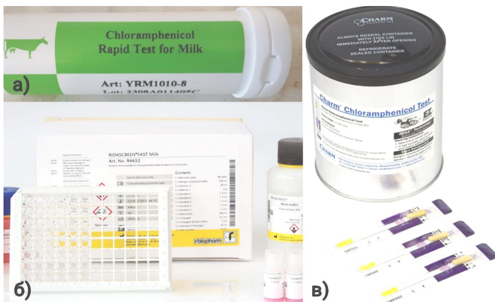
Рис. 3. Набори імуноферментних експрес-тестів для якісного виявлення хлорамфеніколу в харчових матрицях: а – BIOEASY® Chloramphenicol Test Strip; б – РІДАСКРІН® Хлорамфенікол; в – CHARM® ROSA Chloramphenicol TEST
