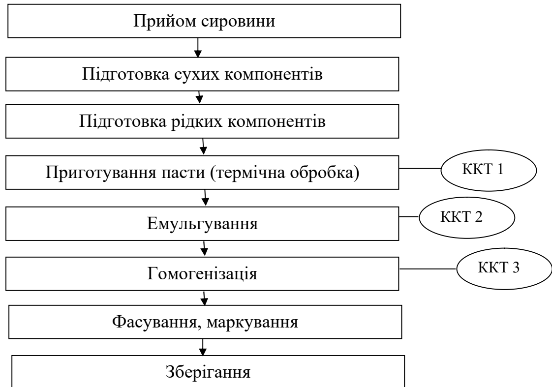
Рис. 4. Блок-схема виробництва майонезів
