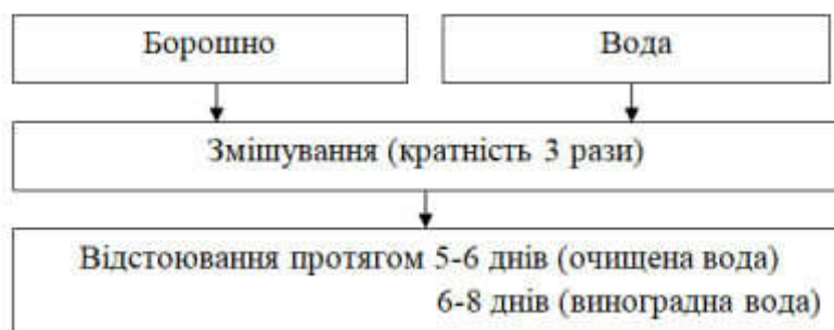
Рис. 7. Технологічна схема виробництва заквасок
