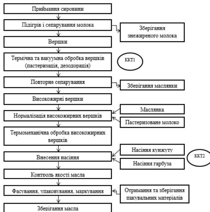
Рис. 10. Блок-схема виробництва масла
